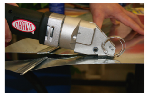
Hut ab! Die Dräco-Falzblechscherer AK3514-2 hat ganze Arbeit geleistet
