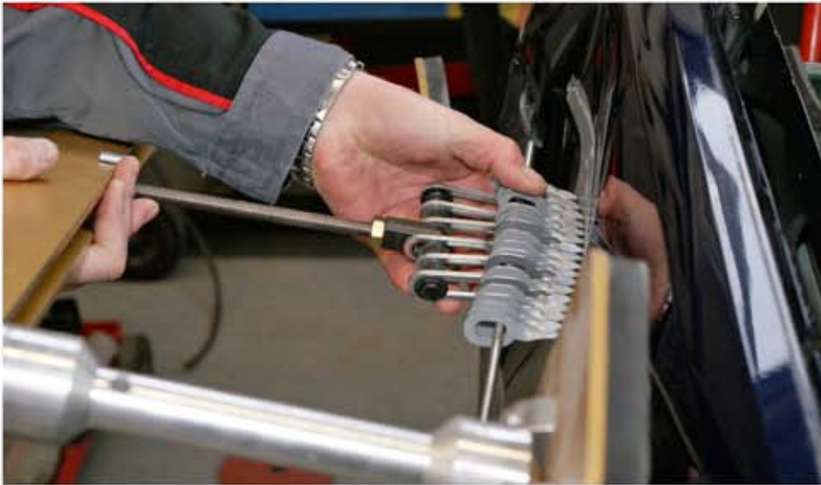
Die Zugbrücke ist so konstruiert, dass eine Ein-Mann-Bedienung problemlos möglich ist
