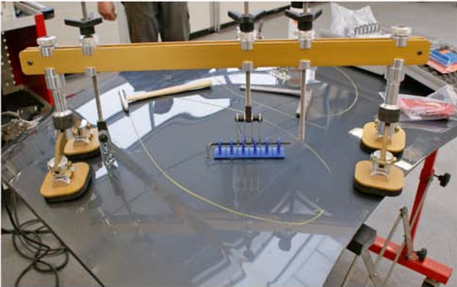
Kein Ausbeulen ohne Klebetechnik! Manche Verformungen lassen sich lackschadenfrei beheben
