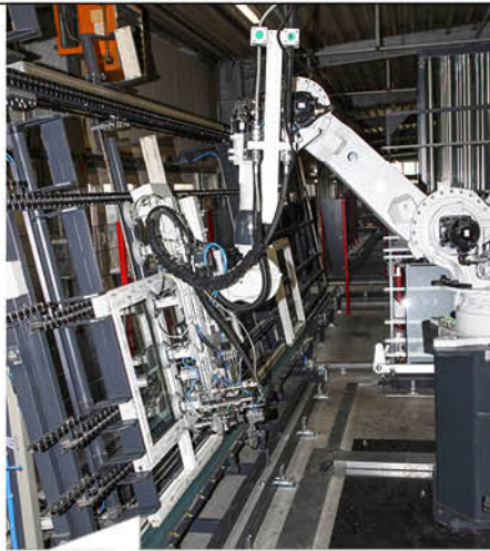
Kleberoboter zur Verklebung und Glaseinsatz im Einsatz bei der Söba Fenster und Türen GmbH (die GLASWELT berichtete im Heft 12/2015).
