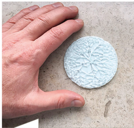
Die kleine Modellscheibe belegt das gute Bruchbild von Teutemacher-ESG aus dem Keraglass-Ofen.
