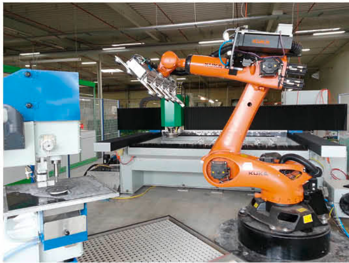
Damit der Roboter die Scheiben zwischen der CNC-Bearbeitung (r.) und der Bohrmaschine (l.) bewegen kann, wurde er mit einem Spezialsauger ausgestattet
