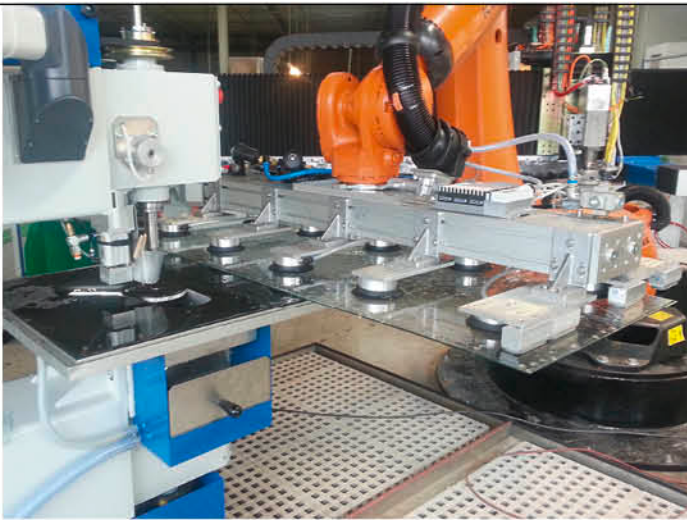
Der Roboter „fädelt“ die Glasscheibe in die Bohrmaschine ein.
