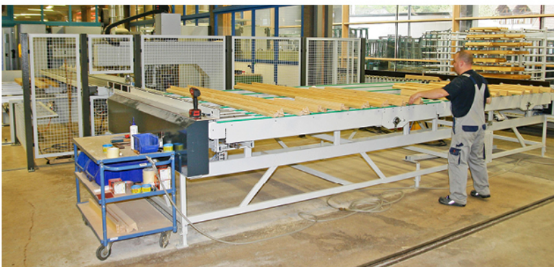
Automatisches Werkstückhandling der BMB 811 auf engstem Raum: Unten werden die Rohkanteln aufgelegt, oben ist der automatische Weitertransport zu erkennen.
