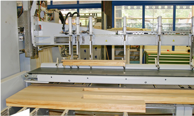
Automatisches Werkstückhandling der BMB 811 auf engstem Raum: Unten werden die Rohkanteln aufgelegt, oben ist der automatische Weitertransport zu erkennen.
