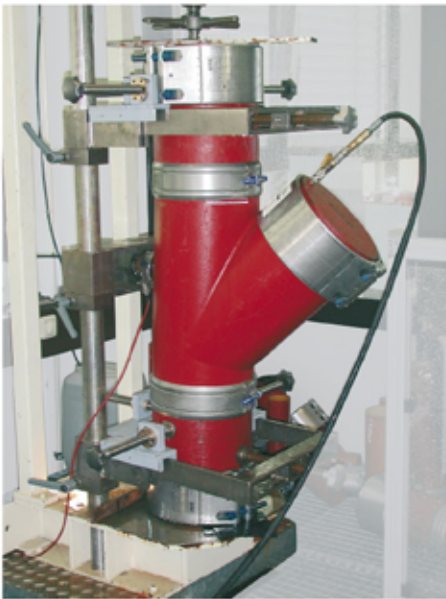
Bild 1 Wasserdichtheitsprüfung unter Innendruck bei Abwinklung und Scherlast
