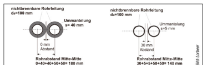
Bild 3 Null-Abstand und trotzdem mehr Platzbedarf.
