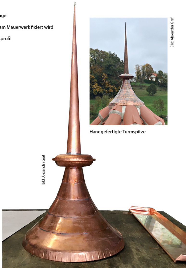
Fünf Kupfersegmente und aufgesetzte flachovale Kugel samt Mustersims (r.)
