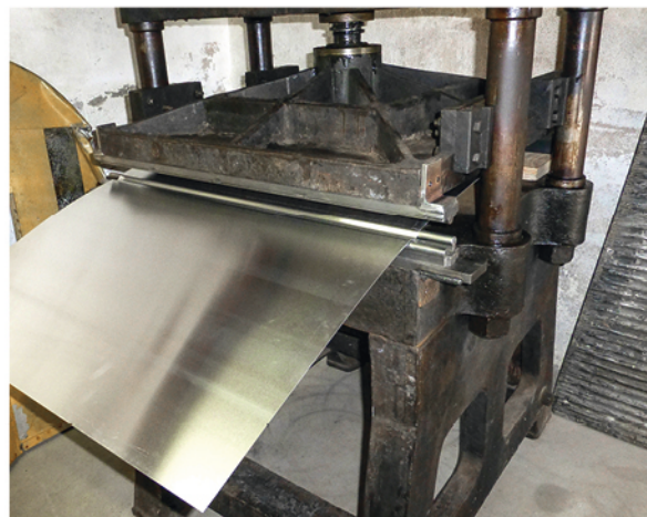
Die 500 kg schwere Presse wurde zur Wellblechfertigung umgebaut
