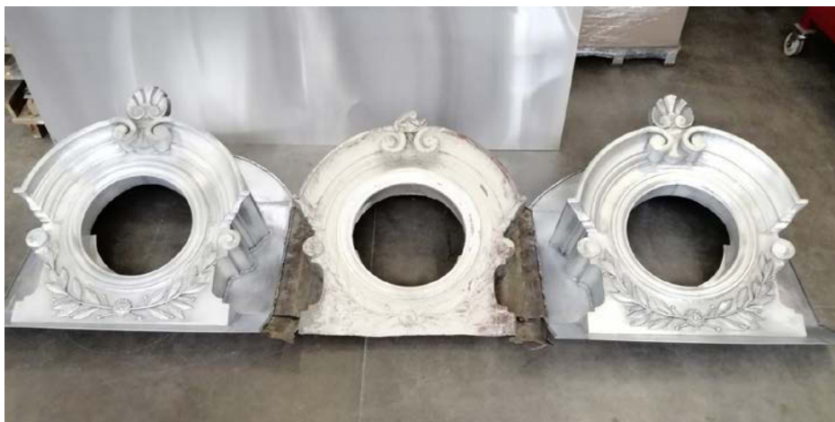
Neuer Glanz: zwei nach historischer Vorlage (Mitte) rekonstruierte Ochsenaugen
