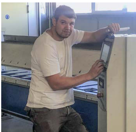
Florian Sittig nimmt Maß und programmiert den Biegeprozess für ein neues Anschlussprofil
