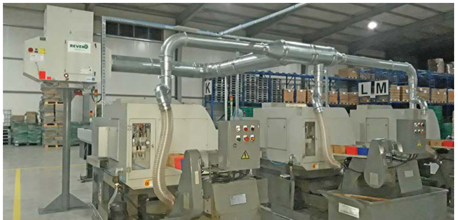
Gruppenabsaugung mit Sammelkanal und Zentralabscheider.
