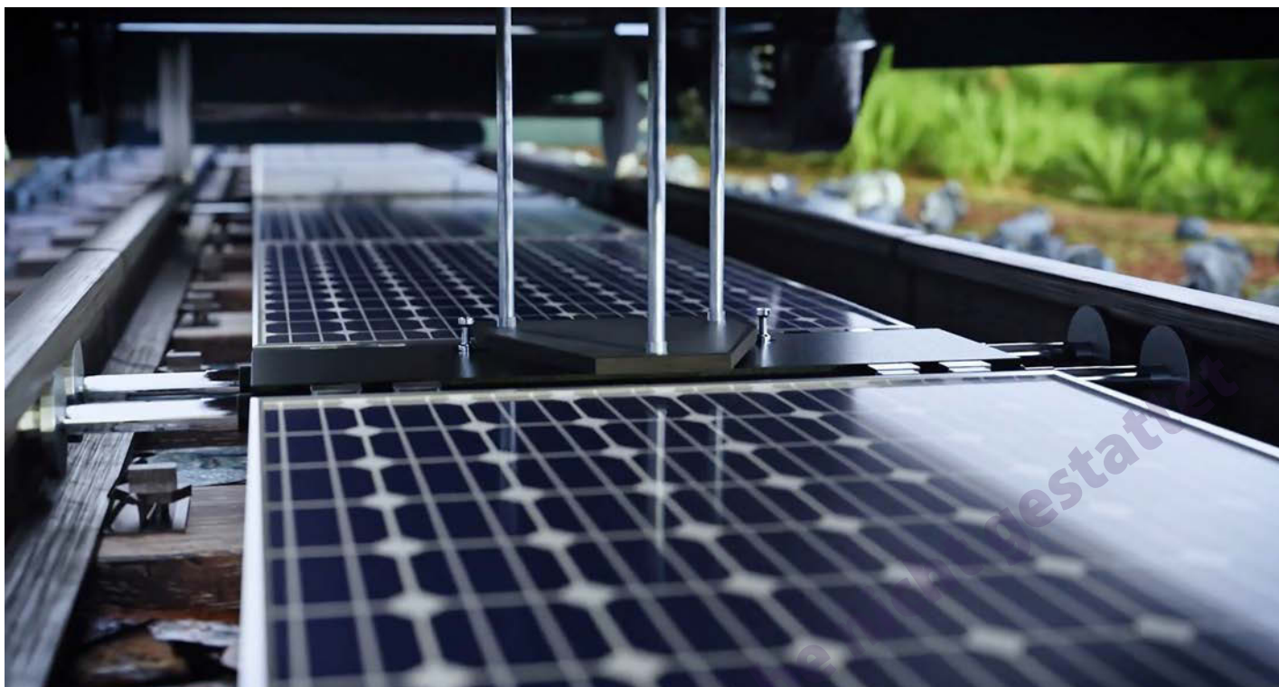
Ein Keil drückt die Riegel nach außen, sodass die Paneele fixiert werden.
