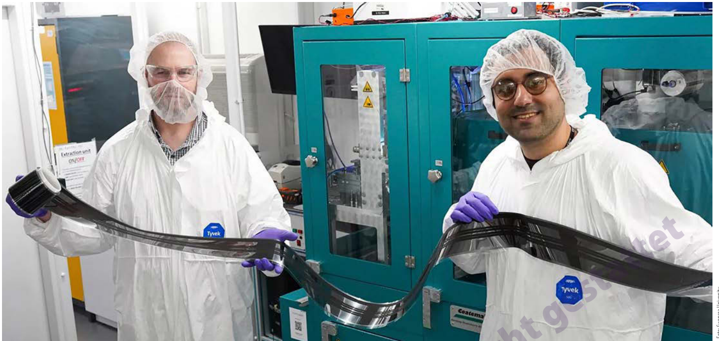
Testrolle mit Perowskitbeschichtung aus dem Labor der Universität Swansea.
