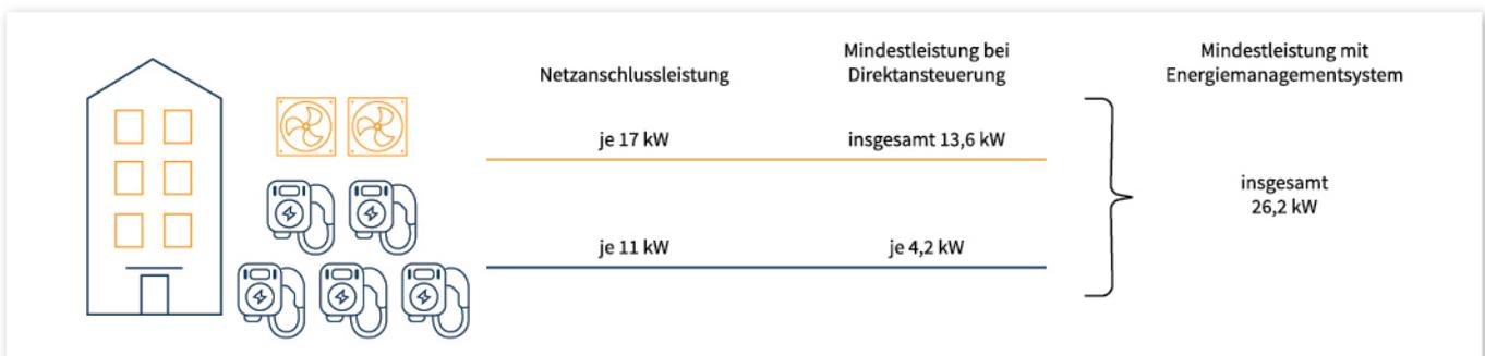
4 Beispielhafte Mindestleistung für ein Mehrfamilienhaus mit zwei Wärmepumpen und fünf Ladestationen
