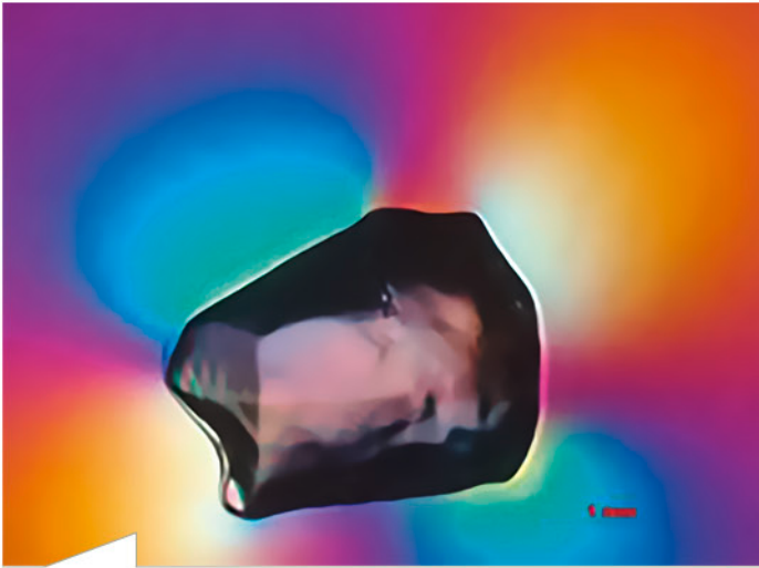
Aluminiumhaltiger Einschluss mit Spannung im Glas
