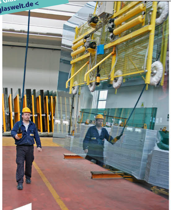
Für die Produktion von 3-fach-ISO sollten ein Kompaktlager mit ca. 75 – 100 Stellplätzen sowie schweres, leistungsfähiges Handlinggerät vorgehalten werden.
