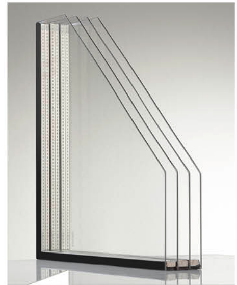
Ein 4-fach-ISO aus vier Dünngläsern kann U g -Werte von bis zu 0,3 W/m 2 K erreichen. Die Fertigung stellt dabei große Anforderungen an den Verarbeiter.
