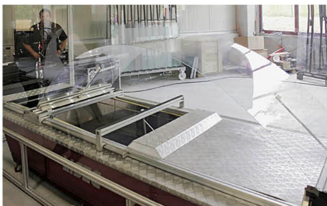
Hier ein vorgespanntes 2 mm Dünnglas im Belastungstest. Solche Gläser lassen sich gleichermaßen für 3-fach- und 4-fach-ISO einsetzen.
