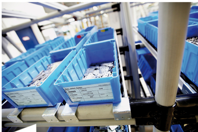
Bei H & W Holzfensterproduktion führte die Installation eines mehrstufigen Kanban-Systems auch zu reduzierten Suchzeiten und gesteigertem Durchsatz.
