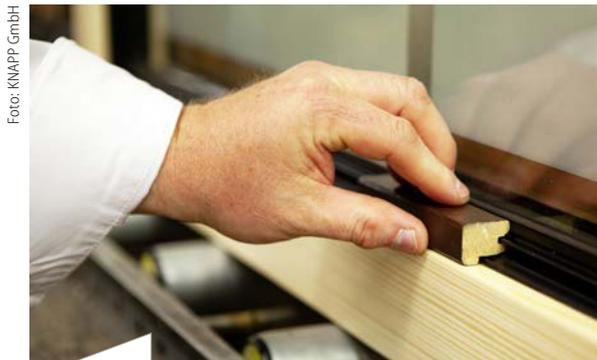
Mit der Anpressschablone wird die FIXclip-Schiene eingesetzt
