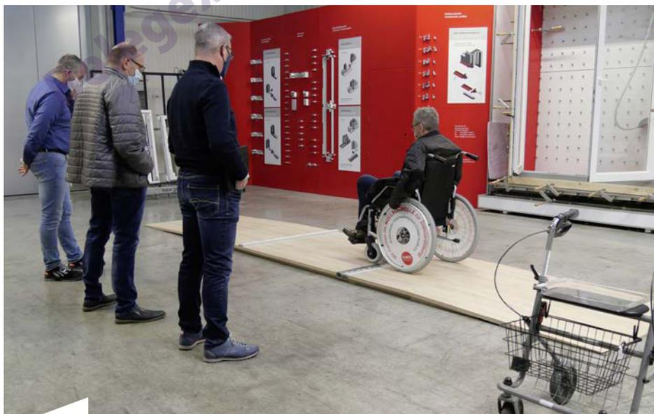
Auf einer Teststrecke wurden alle Teilnehmer im Versuch mit einem Rollstuhl oder Rollator von der 20 mm hohen Türschwelle ausgebremst.
