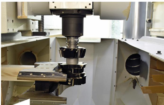
Mit dem ProfilCut Q Premium Werkzeug von Leitz lassen sich Schnittgeschwindigkeiten bis zu 120 m/s realisieren.
