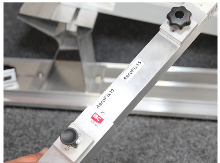
Die verstellbare Messlehre ist eine effektive Hilfe beim schnellen Aufbau verschiedener Montagesysteme von IBC Solar.
