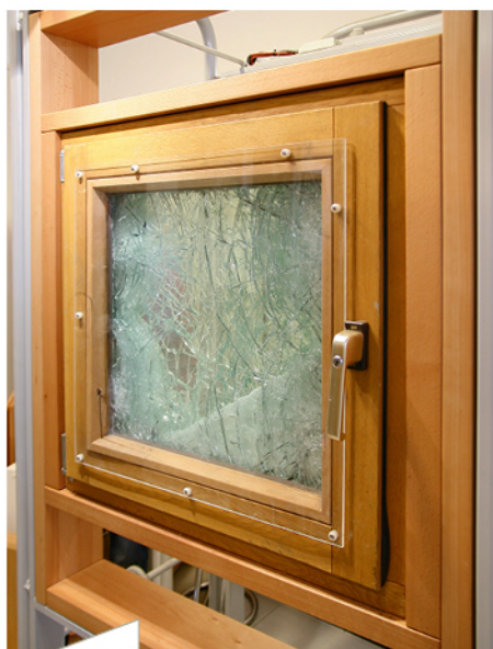
So sehen geprüfte Elemente nach dem Angriff aus.
