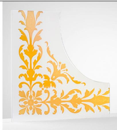
**Reproduktion eines geätzten Überfangglases: Das Motiv wurde einem geätzten Überfangglasfenster entnommen, digital nachgezeichnet und mittels Siebdruck auf Floatglas übertragen. Es handelt sich um ein Kombinationsverfahren mit keramischen Pigmenten der „Kollektion Transparent und Ätzimitation“.**
